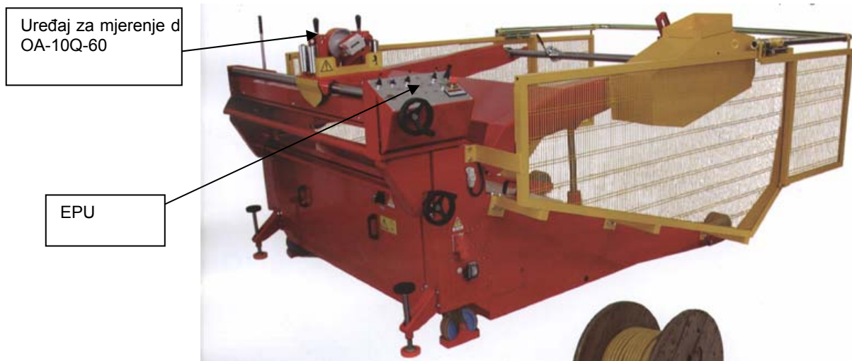
Slika 2: Stroj za poluautomatsko i automatsko namatanje žice i kabela tipa CD-22 M3
